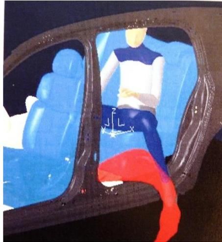
*Simulation de la trajectoire de sortie de pied à l'arriere*
